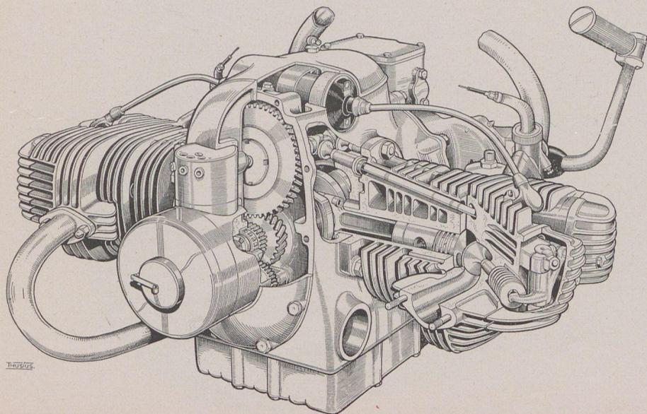
Triebwerk des 800 ccm 22 PS
